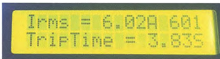
รูปที่ 4.44 หน้าจอ LCD แสดงค่ากระแสและเวลาเมื่อปลดดวงจรที่ 600% ของกระแสเริ่มต้น ของ Normal Inverse-Time Overcurrent Relay
