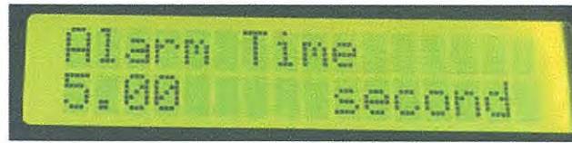
รูปที่ 3.12 หน้าจอ LCD แสดงการตั้งค่า Alarm Time
