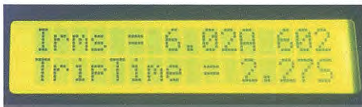
รูปที่ 4.46 หน้าจอ LCD แสดงค่ากระแสและเวลาเมื่อปลดวงจรที่ 600% ของกระแสเริ่มต้นของ Extremely Inverse-Time Overcurrent Relay
