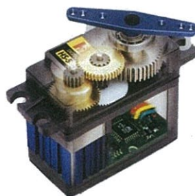
รูปที่ 2.2 ลักษณะโครงสร้างภายในของเซอร์โวมอเตอร์
