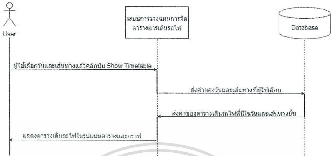
รูปที่ 3.5 Sequence Diagram ของระบบ Show Timetable
