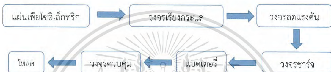
รูปที่ 3.4 แสดงการขั้นตอนการทำงานของวงจรเก็บเกี่ยวพลังงาน
