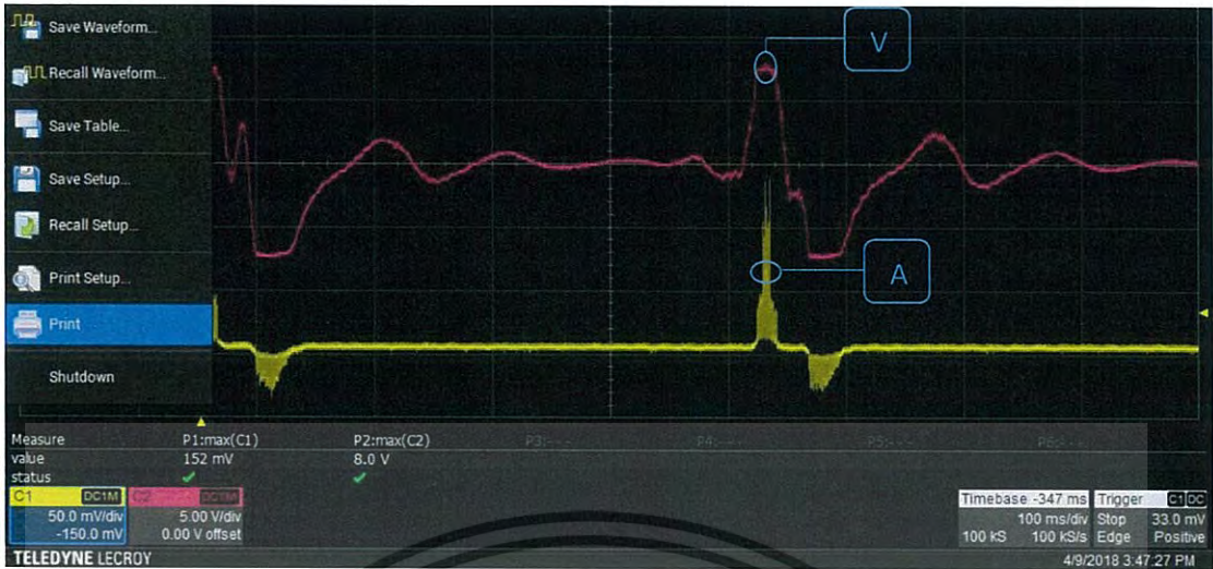
รูปที่ 4.4 คลื่นแรงดันไฟฟ้าและกระแสไฟฟ้าด้านเข้าครั้งที่ 1
