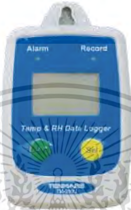
รูปที่ 3.8 Temperature Humidity USB Datalogger (TM-305U) ของบริษัท TENMARS ELECTRONICS
