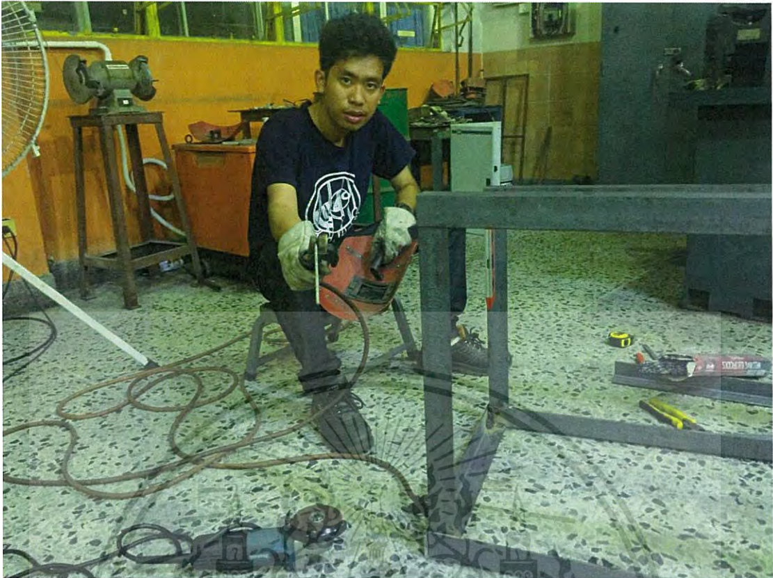
รูปที่ 4.3 ภาพการทำโครงสร้างของระบบวัดกำลังเครื่องยนต์
