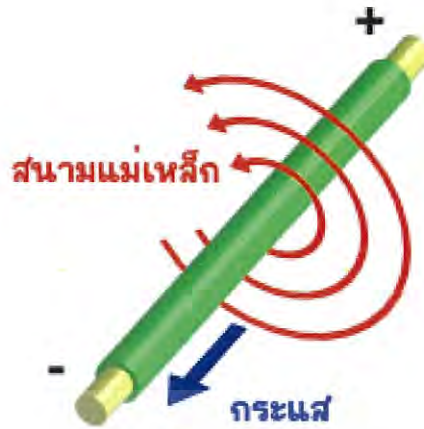
รูปที่ 2.12 ภาพแสดง ทิศทางการไหลของสนามแม่เหล็กและกระแส
