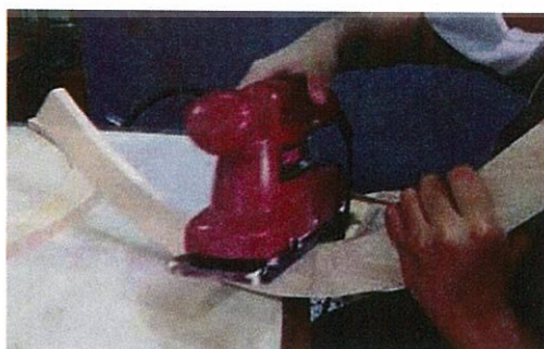
รูปที่ 3.10 แสดงการขัดไม้ด้วยเครื่องขัดกระดาษทราย
