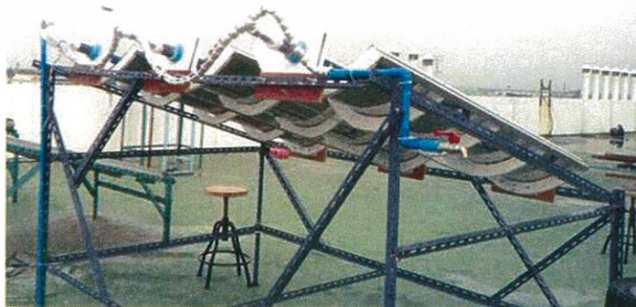
รูปที่ 3.29 เดินระบบท่อน้ำเข้า และท่อน้ำออก
