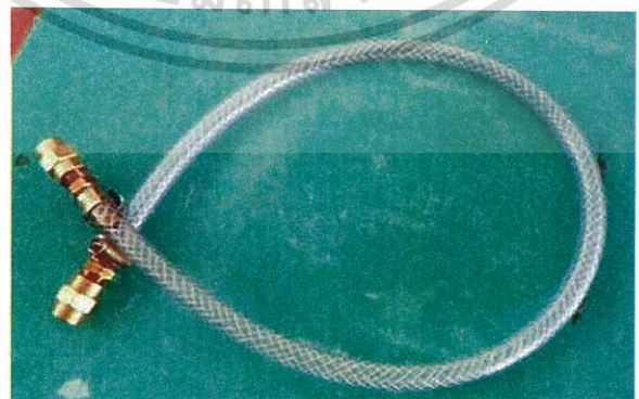
รูปที่ 3.26 ต่อข้อต่อตรงทองเหลืองเข้ากับปลายสายยางทนความร้อนแต่ละด้าน
