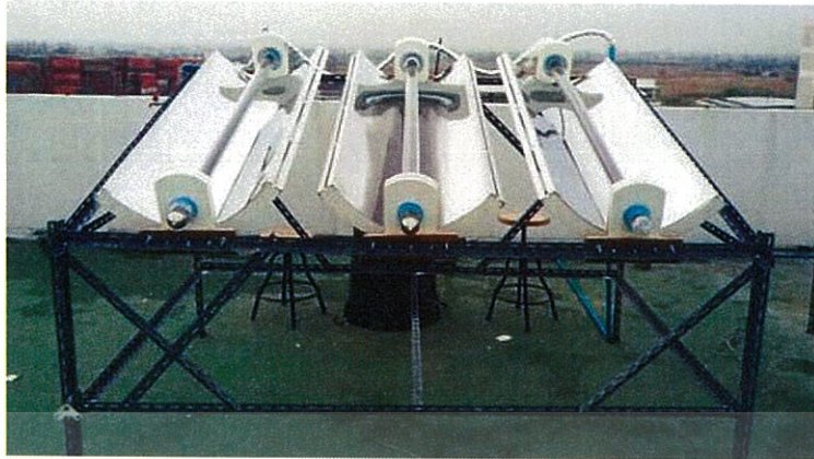
รูปที่ 3.30 รางรวมแสงแบบพาราโบลิกสมบูรณ์
