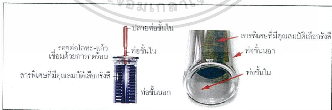
รูปที่ 2.8 ส่วนประกอบของแผ่นรับแสงแบบหลอดแก้วสุญญากาศ
