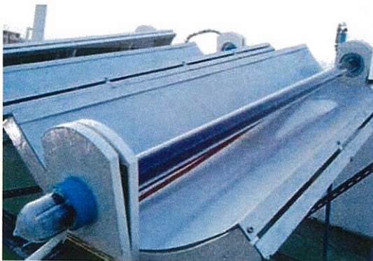
รูปที่ 3.23 ติดตั้งท่อแก้วสุญญากาศเข้ากับรางพาราโบลา
