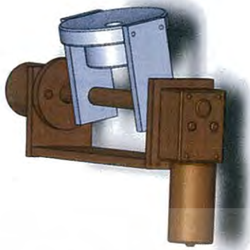
รูปที่ 3.20 แสดงโครงสร้างส่วนแนวการเคลื่อนที่อัลติจูดหรือการเคลื่อนที่แนวตั้ง
