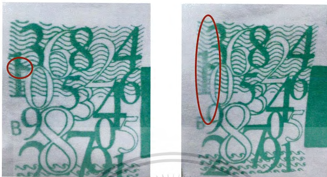
รูปที่ 4.13 การหลุดของหมึกพิมพ์สูตร P(5)60A40
