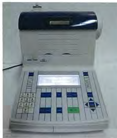
รูปที่ 2 เครื่องวัดความหนาแน่นรุ่น Toledo DE40 จากบริษัท Mettler
