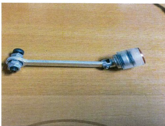
รูปที่ 3.4 เฟลาข้อเหวี่ยงที่เชื่อมต่อกับลูกสูบกำลัง
