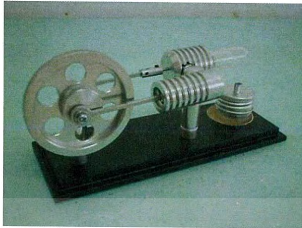
รูปที่ 2.4 เครื่องยนต์สเตอร์ลิงแบบแกมมาชนิดอุณหภูมิต่ำ
