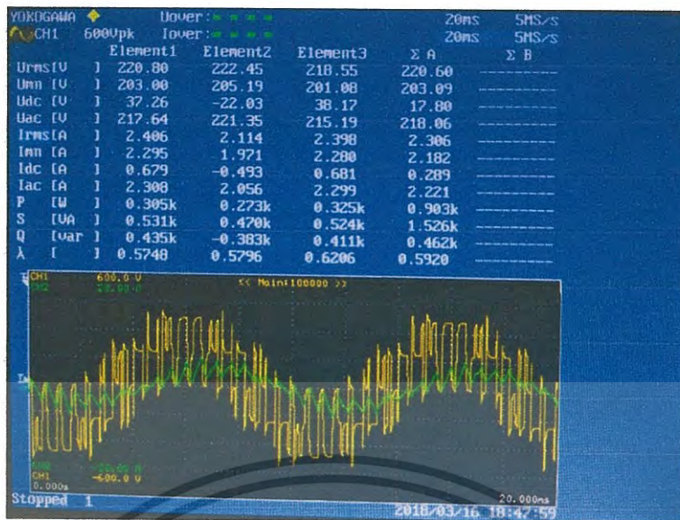
รูปที่ 4.61 แรงดันไฟฟ้าและกระแสไฟฟ้าที่ภาระ 50% ของพิกัด
