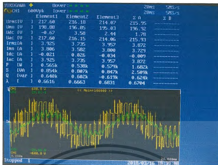
รูปที่ 4.63 แรงดันไฟฟ้าและกระแสไฟฟ้าที่ภาระ 100% ของพิกัด
