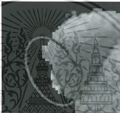
รูปที่ 2.9 ภาพตัวอย่างความคลาดเคลื่อนเมื่อซ้อนภาพระยะลึกกับภาพสี
