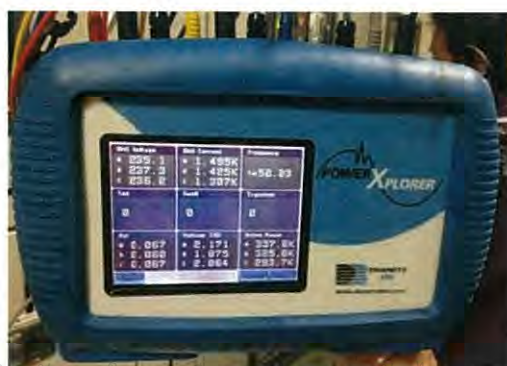
รูปที่ 6 เครื่องวัดคุณภาพไฟฟ้าที่ใช้ตรวจวัดคุณภาพไฟฟ้าผลิตภัณฑ์ Dranetz BMI
