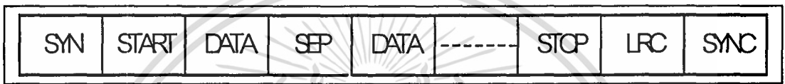
ภาพที่ 10 รูปแบบของการบันทึกข้อมูลทีบันทึกในแตร็กที่ 2 บนบัตรแถบแม่เหล็ก ที่มา : คฤทธิและภาณุศร,2541
