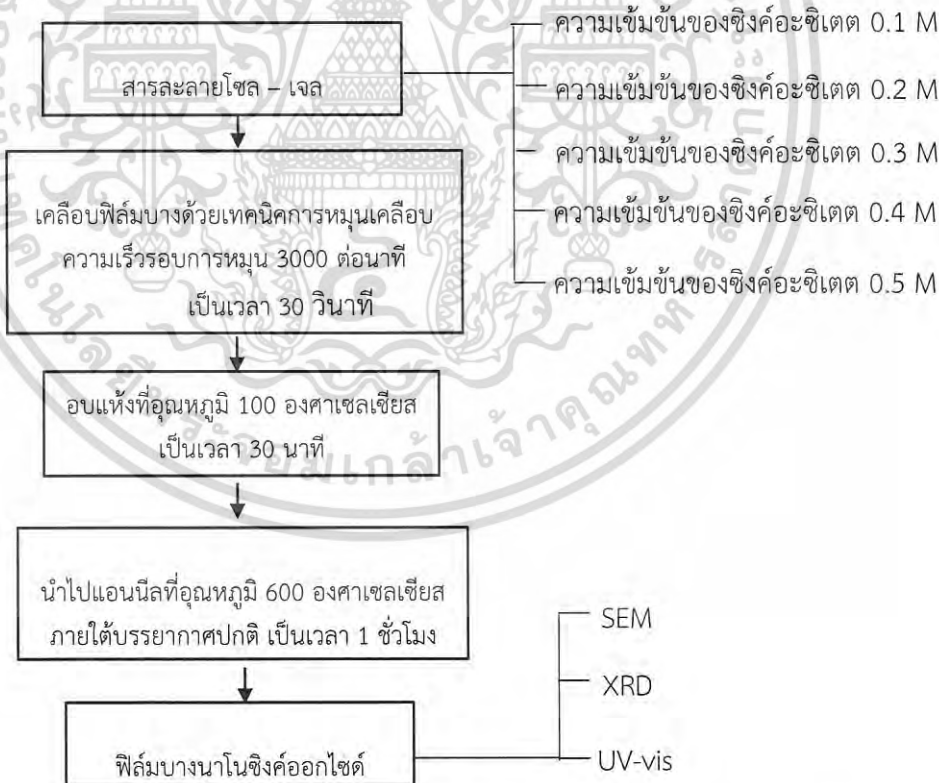
รูปที่ 3.13 แผนภาพแสดงการเตรียมฟิล์มบางนาโนซิงค์ออกไซด์ด้วยวิธีการหมุนเคลือบ ภายใต้เงื่อนไขการเปลี่ยนแปลงความเข้มข้นของซิงค์อะซิเตต
