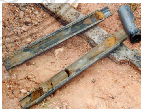
รูปที่ 3.9 กระบอกรับตัวอย่างดิน (ดร.พรพจน์ และ ผศ.ดร.ธนาตล, 2552)
