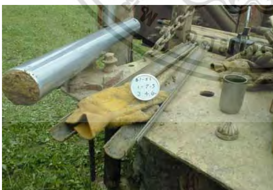
รูปที่ 3.9 กระบอกรับตัวอย่างดิน (ดร.พรพจน์ และ ผศ.ดร.ธนาตล, 2552)
