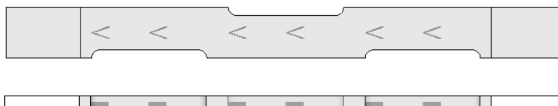
รูปที่ 5.61 แบบจำลองทางกายภาพของการติดตั้งปีกรูปตัววี ติดตั้งแบบ 6 แถว
