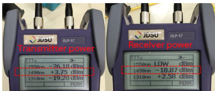
รูปที่ 4.5 ค่ากำลังรับ-ส่ง ระหว่าง OLT กับ ONT
