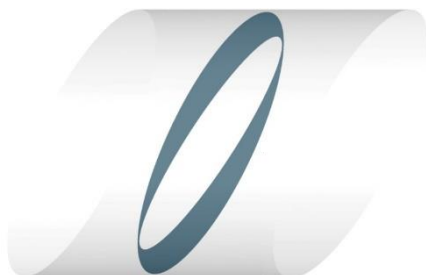
รูปที่ 5.3 แบบจำลองสามมิติของท่อกลมที่มีวงแหวนวอเท็กซ์ด้านในแบบ 1 โมดูล
