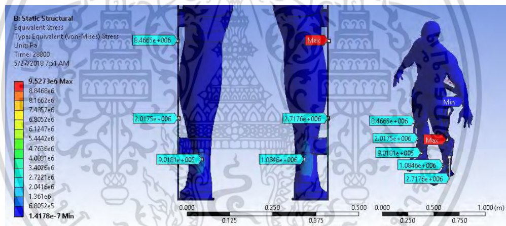
รูปที่ 4.73 ตำแหน่งที่เกิดความเค้นสูงสุดในอุปกรณ์ที่ทำจากคาร์บอนไฟเบอร์
