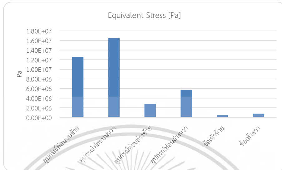
รูปที่ 4.110 กราฟแสดงความเค้นที่เกิดขึ้นในแต่ละส่วนของอุปกรณ์ที่ทำจากสแตนเลสสตีล
