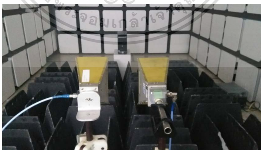
รูปที่ 4.3 การติดตั้งการวัดช่องสัญญาณการสะท้อนสำหรับการโพลาไรซ์แนวนอน
