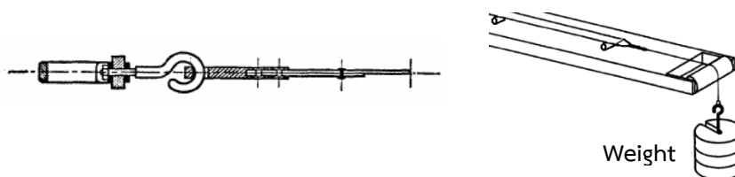
รูปที่ 3.4 การขึงตึงสายวัดโดยการถ่วงด้วยตุ้มน้ำหนัก
