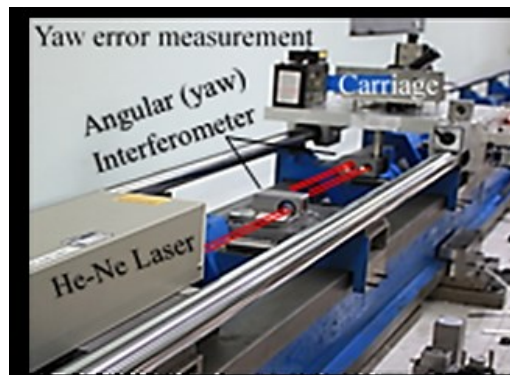
รูปที่ 4.4 การวัดความคลาดเคลื่อนของยอร์ด้วยเลเซอร์อินเตอร์เฟียโรมิเตอร์
