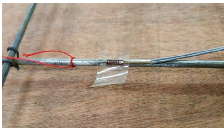
รูปที่ 3.16 การติดตั้งอุปกรณ์วัดการยืดหดตัว (Strain Gauge) บนเหล็กเสริม
