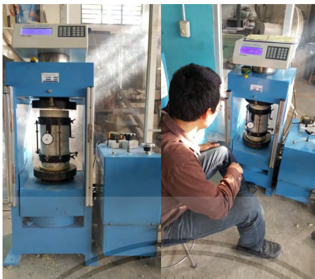
รูปที่ 3.6 ทดสอบแท่งตัวอย่างคอนกรีตโพมซีเมนต์รูปทรงกระบอกมาตรฐานที่ทดสอบหา โมดูลัสยืดหยุ่น และกำลังอัดประลัย
