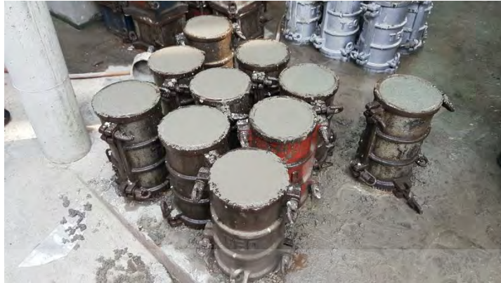
รูปที่ 3.23 แท่งตัวอย่างคอนกรีตน้ำหนักธรรมดารูปทรงกระบอกมาตรฐานในตัวอย่างพื้นทดสอบ
