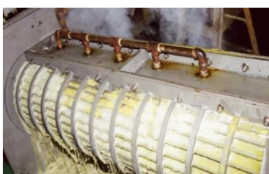
รูปที่ 1.2 เครื่องคั้นแบบเกลียวอัดในกระบวนการคั้นน้ำสับปะรด [5]
