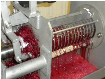
รูปที่ 1.3 เครื่องคั้นแบบเกลียวอัดในกระบวนการคั้นน้ำแครนเบอร์รี่ [6]
