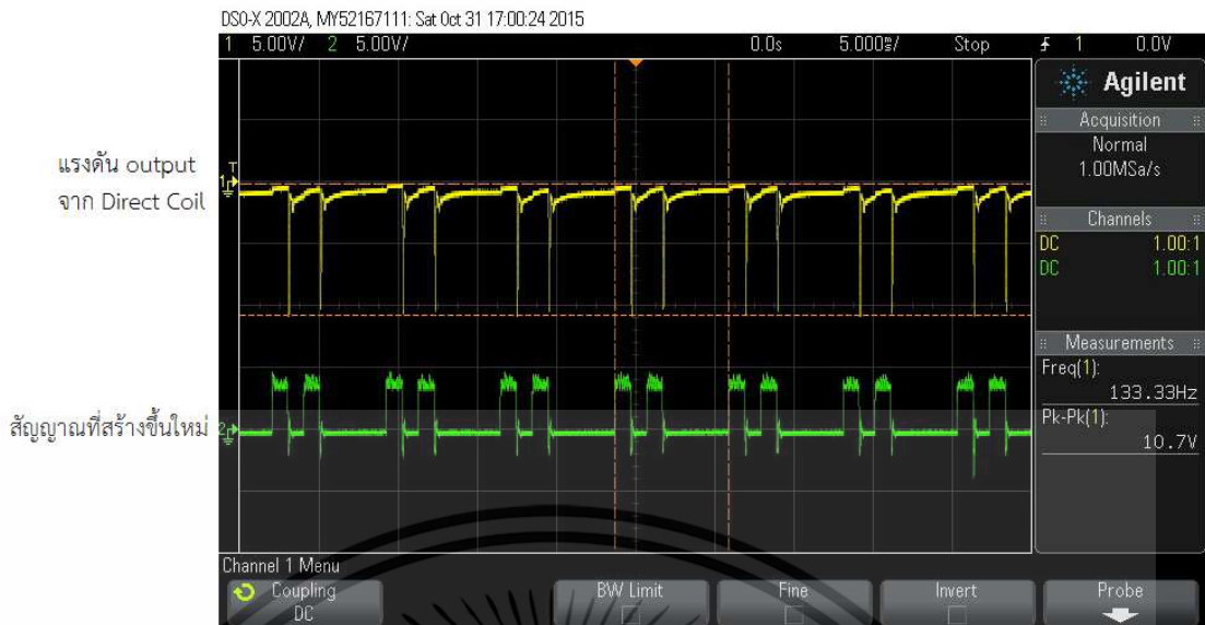
รูปที่ 4.29 สัญญาณแรงดันจากการจุดระเบิดที่วัดได้จากชุดวงจรคอยล์จุดระเบิด (บน) และ สัญญาณที่ใช้ในการจุดระเบิดที่สร้างขึ้นใหม่ 2 พัลส์ (ล่าง) ที่ความเร็วรอบเครื่องยนต์ 8000 rpm
