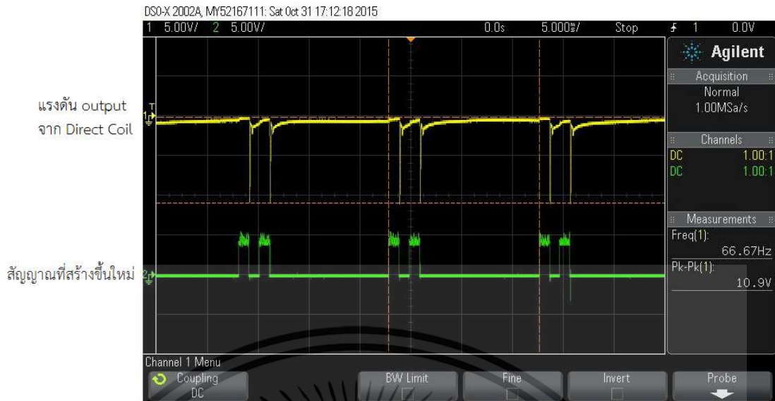
รูปที่ 4.15 สัญญาณแรงดันจากการจุดระเบิดที่วัดได้จากชุดวงจรถอดสัญญาณจุดระเบิด (บน) และ สัญญาณที่ใช้ในการจุดระเบิดที่สร้างขึ้นใหม่ 2 พัลส์ (ล่าง) ที่ความเร็วรอบเครื่องยนต์ 4000 rpm
