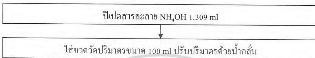
รูปที่ 3.9 แผนภูมิแสดงการเตรียมสารละลายแอมโมเนียมไฮดรอกไซด์
