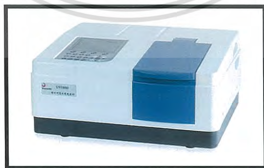
รูปที่ 2.31 แสดงเครื่องวัดค่าการดูดกลืนแสง (UV-Vis Spectroscopy) [41]
