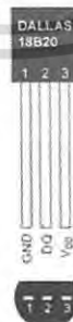
รูปที่ 2.5 ขาและตัวถัง TO-92 ของไอซี DS18B20
