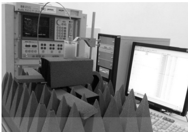
รูปที่ 3.5 การวัดคุณสมบัติทางไฟฟ้าของน้ำส้มเขียวหวาน
