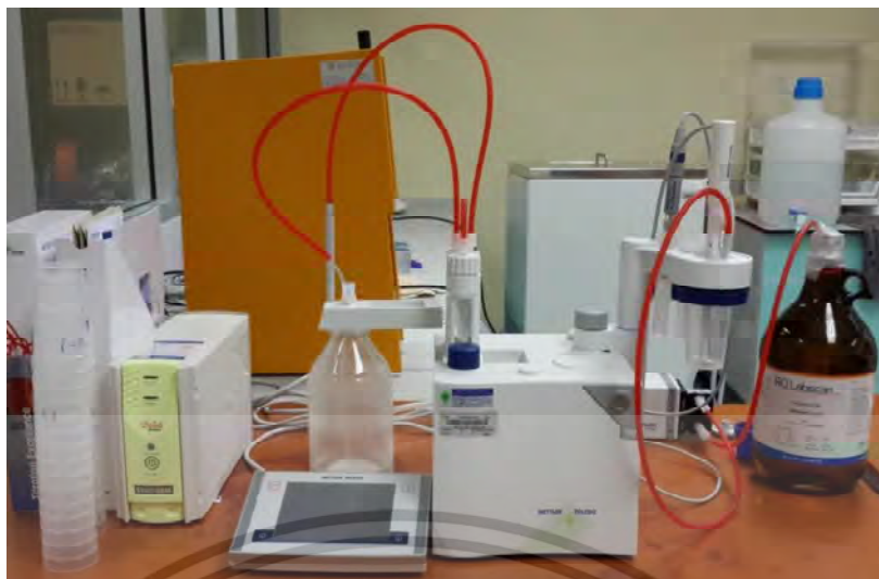
รูปที่ 3.8 เครื่องไตเตรทอัตโนมัติ (Automatic Titrator) ยี่ห้อ Mettler Toledo รุ่น T50
