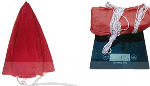
ภาพที่ 3.16 ร่มชูชีพสภาพเสร็จสมบูรณ์และมวลของร่มชูชีพ
