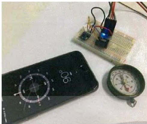
ภาพที่ 4.13 การเทียบทิศของ โมดูลกับเข็มทิศแบบตลับและแสดงค่าเป็นองศาของทิศตะวันออก
