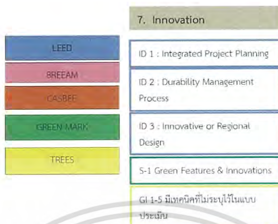
ภาพที่ 2.13 แสดงการเปรียบเทียบเนื้อหาของเกณฑ์การประเมินอาคารหัวข้อ Innovation ที่มา: ดัดแปลงมาจากจิโรจ กาญจนภรณ์, 2555.
