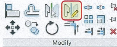
รูปที่ 2.17 : รูปแสดงคำสั่ง mirror – draw axis
