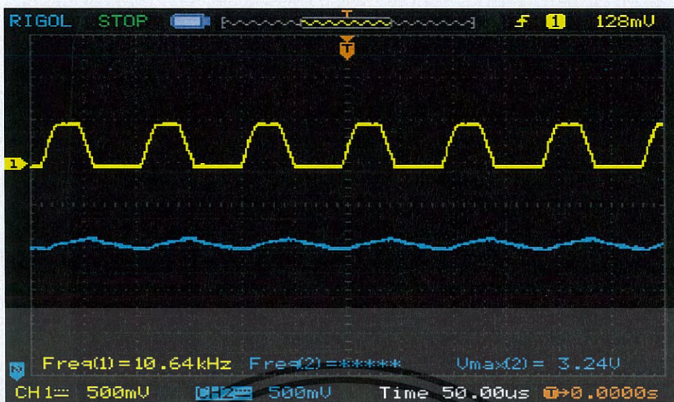
รูปที่ 4.2 รูปแสดง Waveform ระหว่างสัญญาณที่วัดได้จากตัวส่ง (Channel 1) และ สัญญาณที่วัดได้จากตัวรับ (Channel 2) ในกรณีสภาพแวดล้อมที่มีแสงอาทิตย์รบกวน ในระยะ 1m
