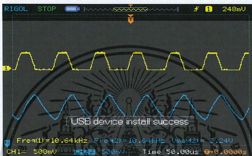
รูปที่ 4.16 รูปแสดง Waveform ระหว่างสัญญาณที่วัดได้จากตัวส่ง (Channel 1) และ สัญญาณที่วัดได้จากตัวรับ (Channel2) ในกรณีสภาพแวดล้อมที่มีแสงอาทิตย์รบกวน ในระยะ 30 cm
