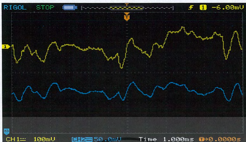
รูปที่ 4.27 รูปแสดงสัญญาณเสียงที่วัดได้โดยประกอบด้วย สัญญาณเสียงที่วัดได้จากภาคส่งสัญญาณ (Channel1) และสัญญาณเสียงที่วัดได้จากภาครับสัญญาณ(Channel2) ที่ระยะ 1.5m
