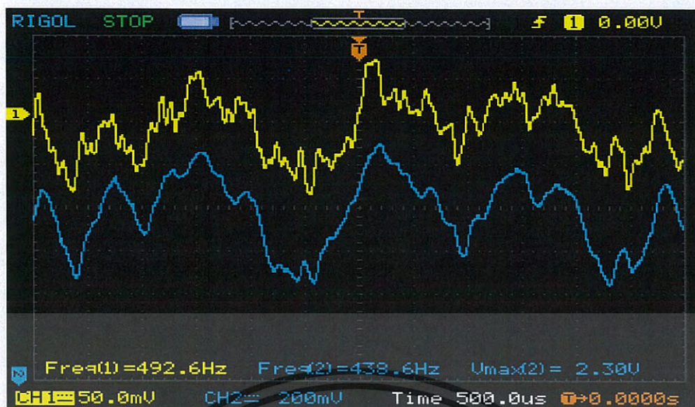
รูปที่ 4.23 รูปแสดงสัญญาณเสียงที่วัดได้โดยประกอบด้วย สัญญาณเสียงที่วัดได้จากภาคส่งสัญญาณ (Channel1) และสัญญาณเสียงที่วัดได้จากภาครับสัญญาณ(Channel2) ที่ระยะ 1m
