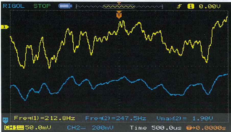
รูปที่ 4.21 รูปแสดงสัญญาณเสียงที่วัดได้โดยประกอบด้วย สัญญาณเสียงที่วัดได้จากภาคส่งสัญญาณ (Channel1) และสัญญาณเสียงที่วัดได้จากภาครับสัญญาณ(Channel2) ที่ระยะ 1.5 m
