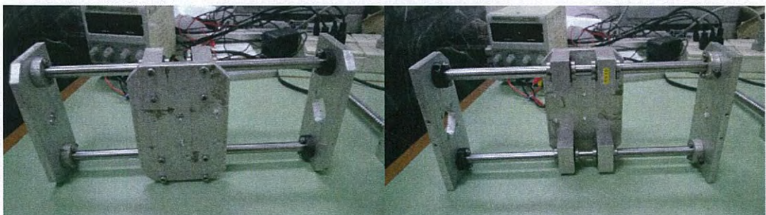
รูปที่ 3.25 ประกอบแท่งยึดลูกปืนกับลิเนียร์รอด
