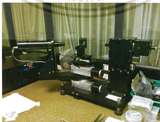
รูปที่ 3.19 แสดงเครื่อง Ellipsometry จากศูนย์เทคโนโลยีอิเล็กทรอนิกส์และคอมพิวเตอร์แห่งชาติ
