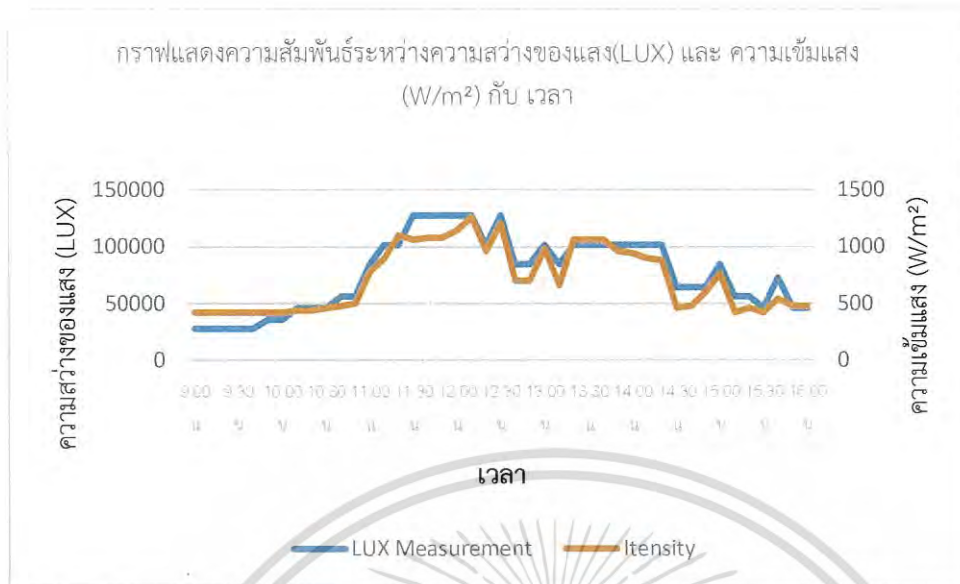
รูปที่ 4.18 กราฟแสดงการเปรียบเทียบระหว่างความสว่างของแสง (LUX) และความเข้มแสง (W/m 2 )
