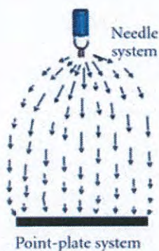
รูปที่ 2.4 การประยุกต์ใช้สนามไฟฟ้ากับการจัดเรียงตัวในของเหลวของเทคนิคอิเล็กโตรสปิน
