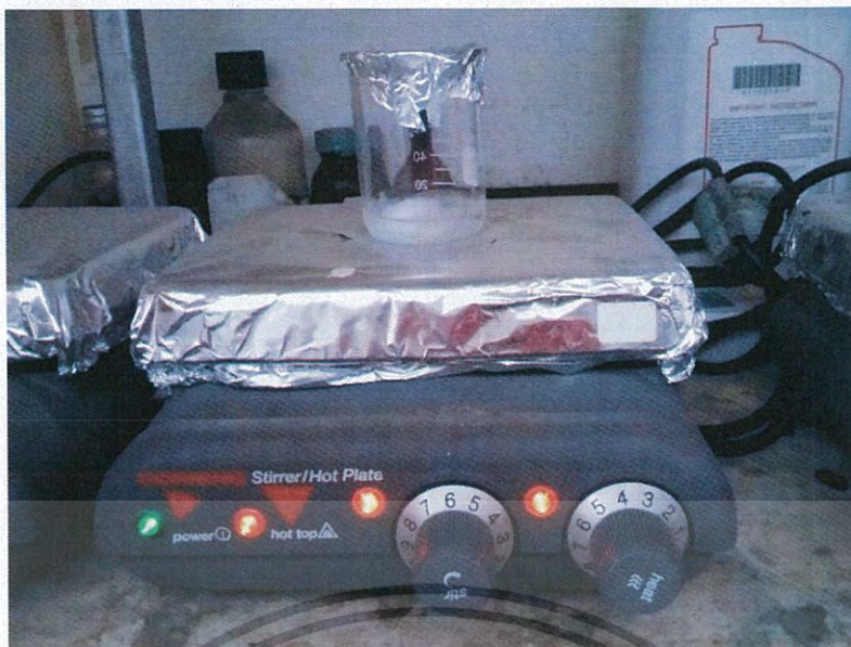
รูปที่ 3.3 การให้ความร้อนและเขย่าสารผงแป้งโพลีไวนิลแอลกอฮอล์
