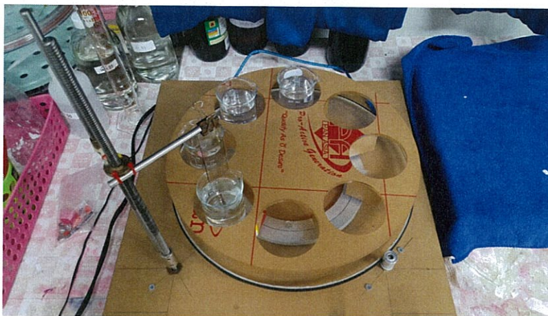
รูปที่ 1.2 เครื่องจุ่มฟิล์มที่สร้างขึ้นเอง
