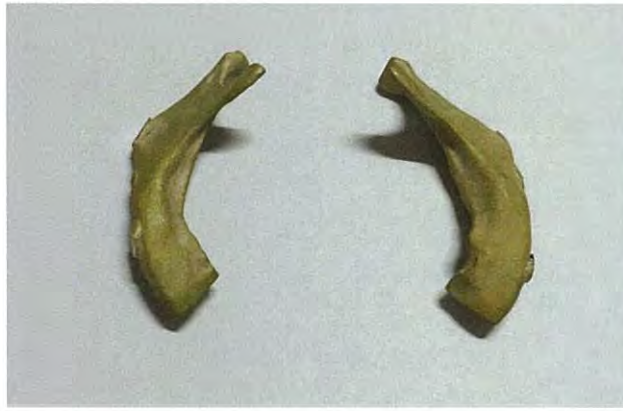
รูปที่ 3.20 ชิ้นงานที่ได้หลังจากการตัดกึ่งก้านโลหะออก
