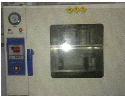
รูปที่ 3.3 ตู้อบ ติดตั้งเครื่องดูดอากาศเพื่อควบคุมอุณหภูมิและความดันอากาศ
