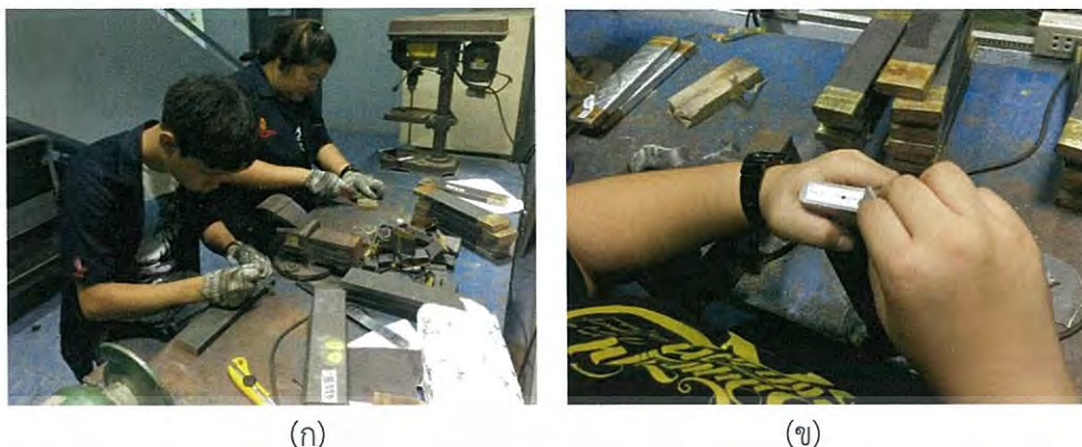
รูปที่ 3.3 การเตรียมชิ้นงานสำหรับทดสอบ (ก) แสดงการปกกฉนวนคอนดักทีฟที่ระยะ 5 เซนติเมตร (ข) แสดงการขัดหน้าตัดให้เรียบ
