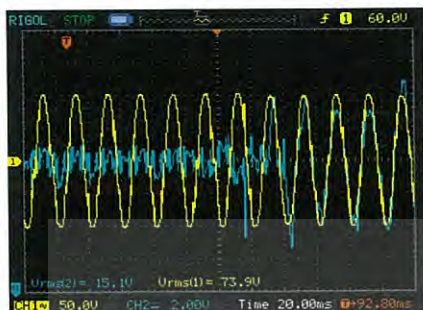
รูปที่ 11 กราฟแรงดันและกระแสทางด้านกริด
