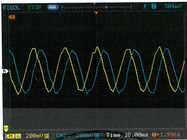
รูป 4.7 Stator Flux ขณะ Steady State
