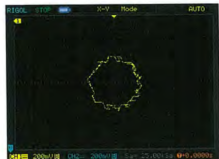
รูปที่ 10 XY-Plot ของ Stator flux
