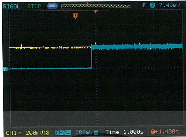
รูปที่ 4.5 การตอบสนองของ Stator flux ขณะ start ที่ 1400 rpm
