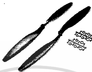
ภาพที่ 2.18 ใบพัดที่ใช้ในเฮลิคอปเตอร์แบบสี่ใบพัด
