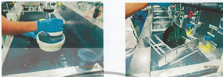
รูปที่ 3.14 การล้างทำความสะอาดแผ่นซีลิกอนเวเฟอร์ด้วยเครื่องล้างระบบอัลตราโซนิก
