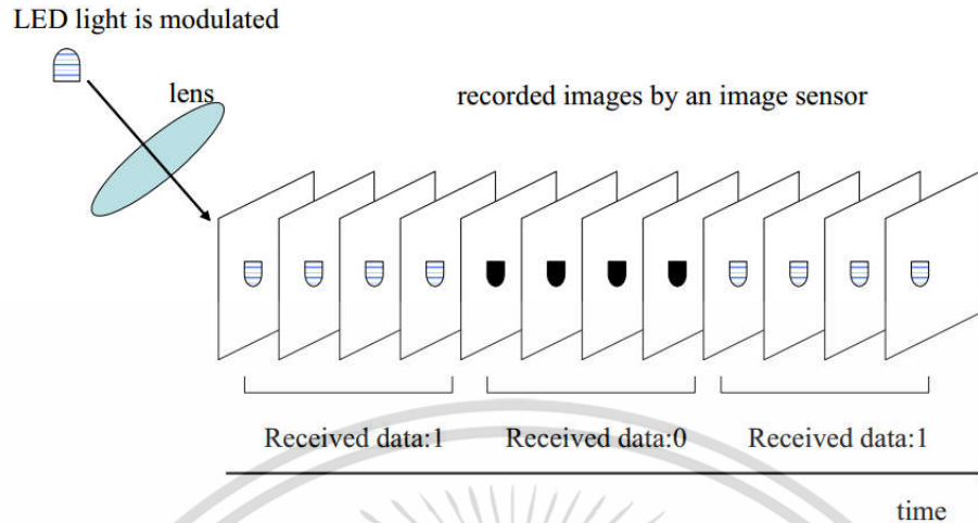
รูปที่ 2.23 กระบวนการรู้จำภาพของเซ็นเซอร์รับภาพเมื่อแสง LED ผ่านเลนส์
