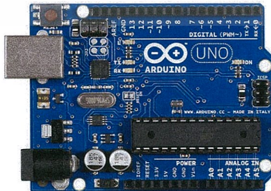
รูปที่ 2.24 บอร์ดไมโครคอนโทรลเลอร์ Arduino UNO R3
