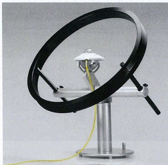
รูปที่ 2.8 ไพรานอมิเตอร์ที่ติดตั้งวงแหวนบังแสง
