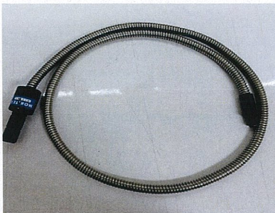
รูปที่ 3.2 สายใยแก้วนำแสงสำหรับนำส่งแสงจากแหล่งกำเนิดแสงไปยังตัวอย่างที่ต้องการทดสอบ
