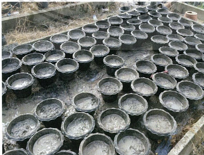
รูปที่ 3.1 ขั้นตอนการเตรียมดินเหนียว
